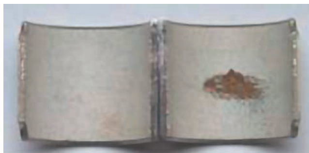
Fig. 36 : Dommage localisé par cavitation
