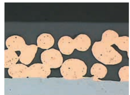
Abb. 4: Beschaffenheit der Gleitfläche im Ausgangszustand
