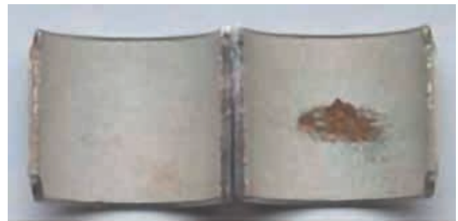
Abb. 36: Örtlicher Schaden durch Kavitation
