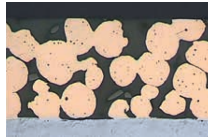
Abb. 5: Beschaffenheit der Gleitfläche am Ende des Einlaufvorgangs
