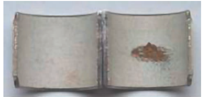
Fig. 36: Averías locales por cavitación
