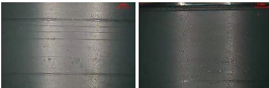
Fig. 38: Cojinete P2, estrías en la superficie de deslizamiento
