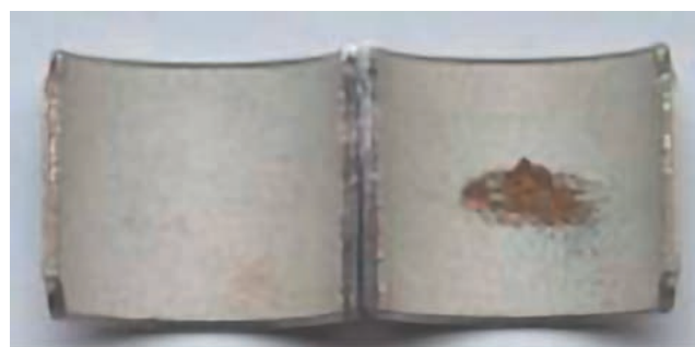
Fig. 36: Danno locale dovuto a cavitazione
