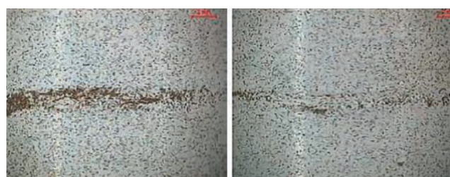
Fig. 37: Danno da erosione nello strato di rodaggio di un cuscinetto a strisciamento P1
