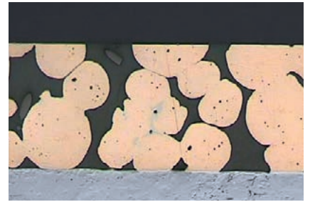
Şek. 8: Çalışma ömrü esnasında kaymalı yüzeyin durumu
