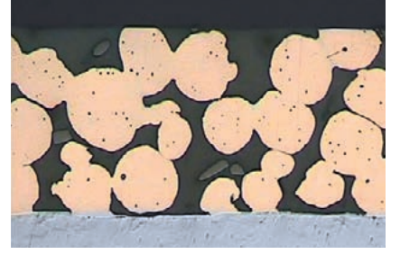
Şek. 5: Alıştırma işleminin sonunda kaymalı yüzeyin durumu
