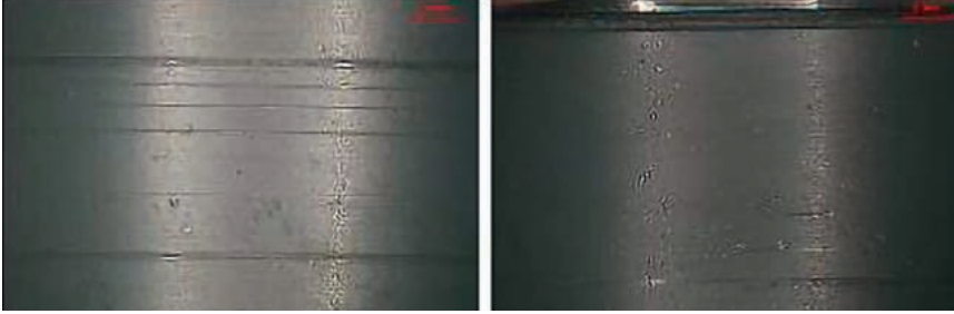
Şek. 38: P2 kaymalı yataklar, çalışma yüzeyinde oluklar
