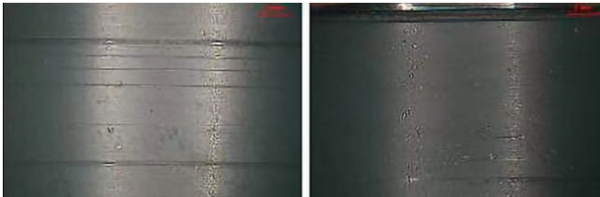
Rys. 38: łożysko ślizgowe P2, blizny w bieżni
