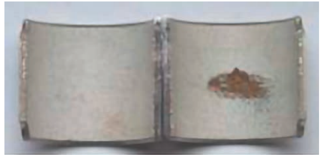
Rys. 36: Lokalne uszkodzenie spowodowane kawitacją
