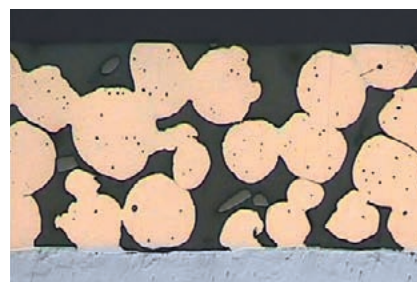
Fig. 5: Características de la superficie de deslizamiento al final del proceso de rodaje
