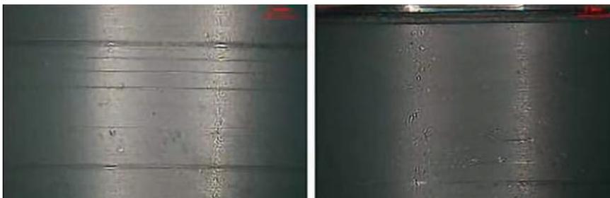
Fig. 38: Cuscinetto a strisciamento P2, rigature nella superficie di scorrimento
