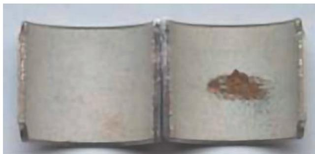
Fig. 36: Danno locale dovuto a cavitazione
