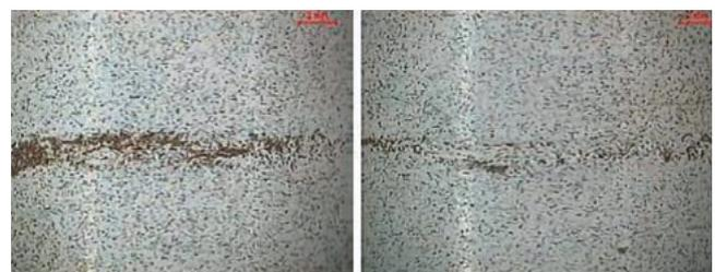
Abb. 37: Schaden durch Erosion in der Einlaufschicht P1-Gleitlager
