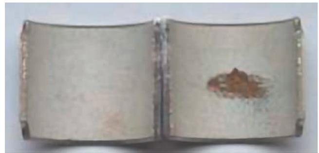
Abb. 36: Örtlicher Schaden durch Kavitation
