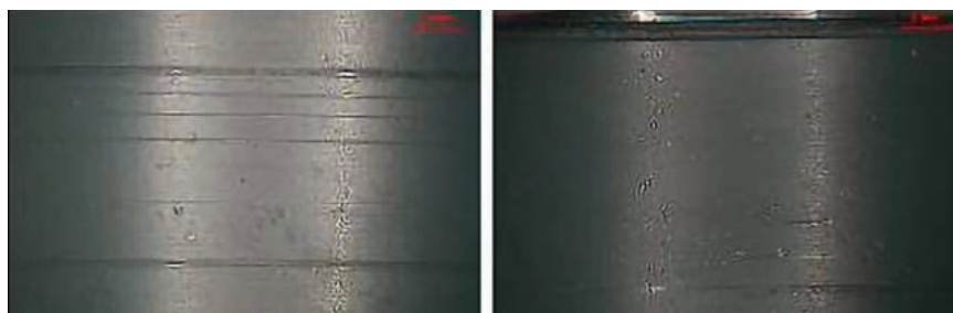
Rys. 38: łożysko ślizgowe P2, blizny w bieżni
