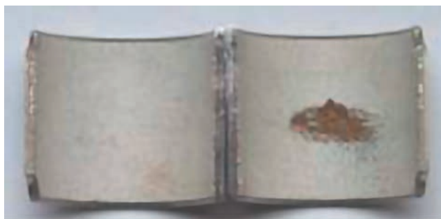
Rys. 36: Lokalne uszkodzenie spowodowane kawitacją
