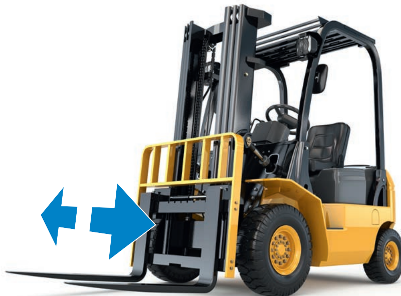
Guida della regolazione laterale delle forche
