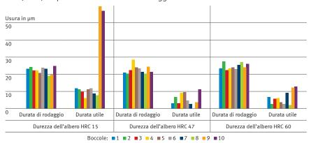
Valutazione banco di prova in rotazione: Usura in  $\mu m$  per alberi di differente durezza HRC
