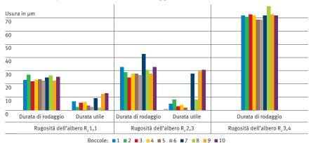
Valutazione banco di prova in rotazione: Usura in  $\mu m$  con **alberi di differente durezza R** $_{z}$ , **durezza dell'albero HRC 60**
